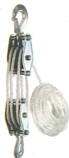
图 11-2-9 滑轮组被广泛应用在吊车等工程机械上
